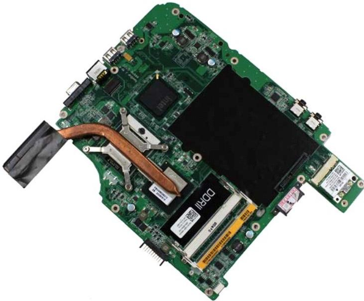
17. Siga el orden indicado en la ilustración siguiente para aflojar los cuatro tornillos que fijan el disipador de calor a la placa base.
