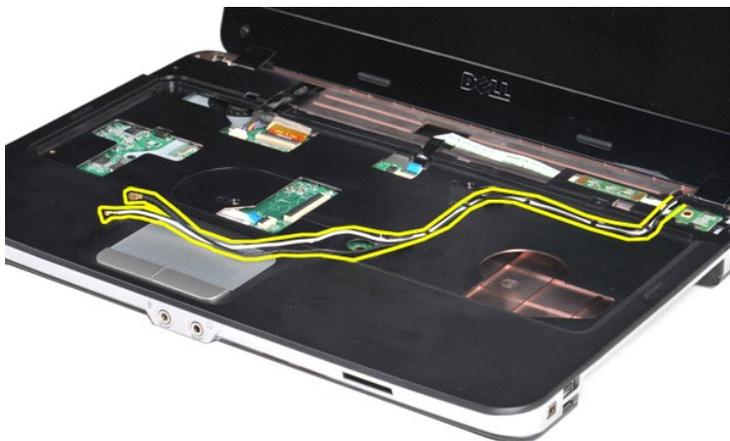
12. Gire el seguro del cable del inversor de la pantalla para desconectar el cable.
