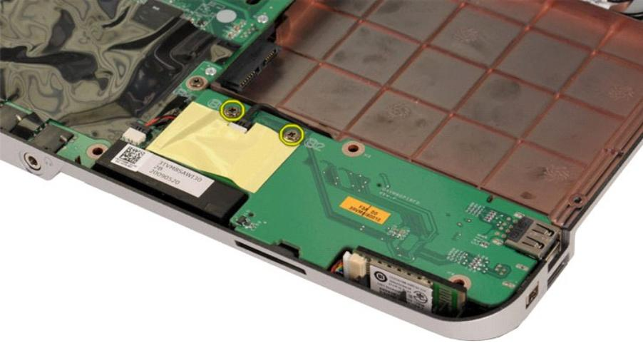
11. Desconecte el cable de módem del conector de la placa de E/S.
