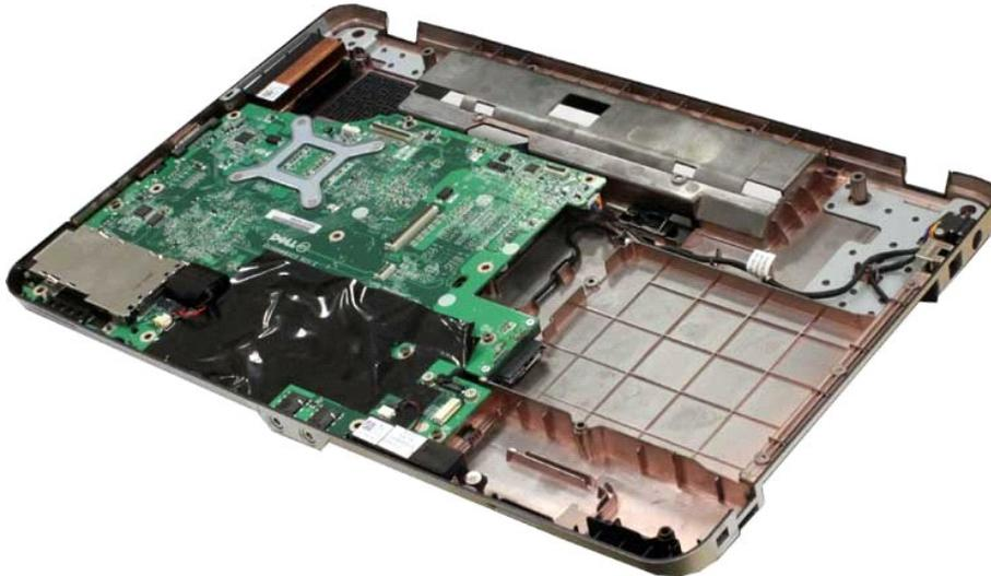
16. Desconecte los cables del altavoz de la placa base.
