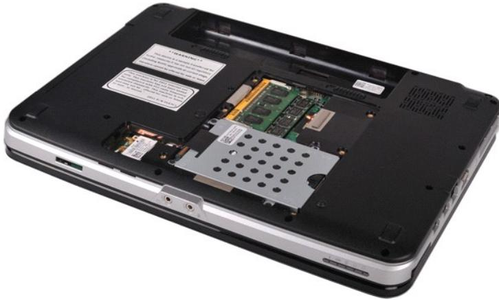
4. Abra cuidadosamente con la punta de los dedos los ganchos de fijación situados en cada extremo del primer conector para módulos de memoria hasta que el primer módulo se expulse.
