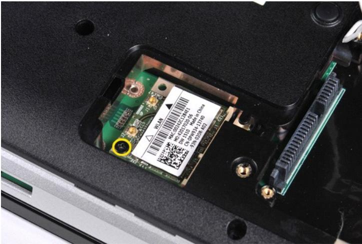
7. Extraiga la tarjeta WLAN del conector de la placa base formando un ángulo de 45 grados.
