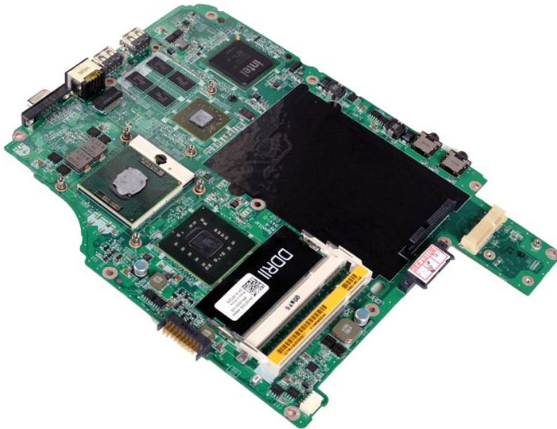
19. Utilice un destornillador de punta plana pequeño y gire el tornillo de leva del zócalo ZIF en el sentido contrario a las agujas del reloj hasta su tope.
