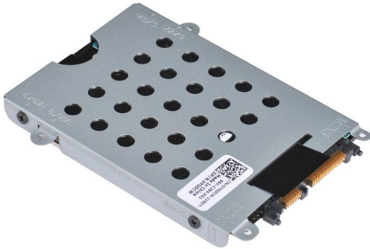
5. Quite los cuatro tornillos (dos a cada lado del soporte) que fijan la unidad de disco duro al soporte de la unidad de disco duro.
