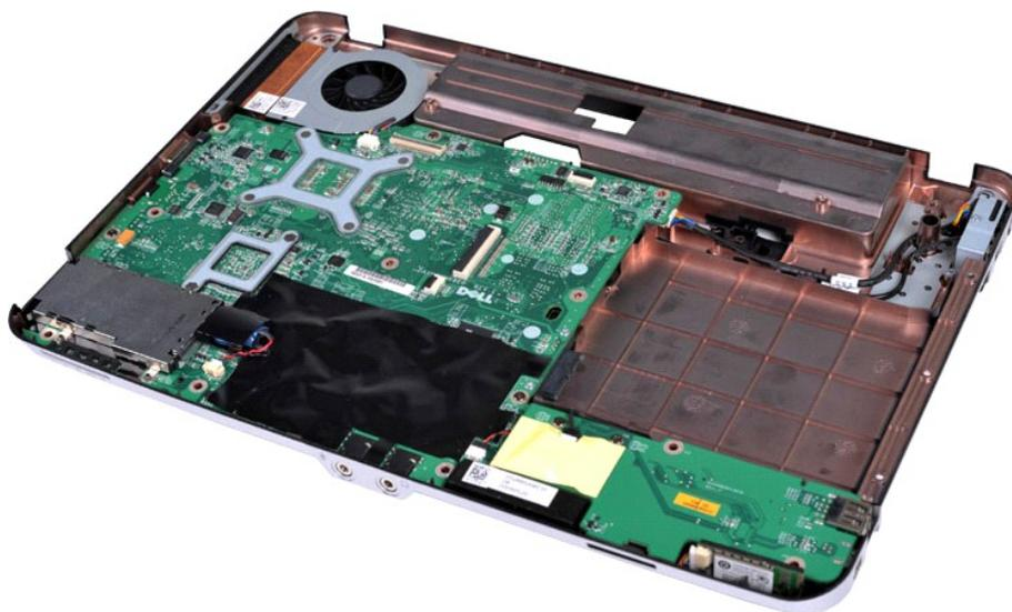
10. Desconecte el cable del ventilador del procesador del conector de la placa base.
