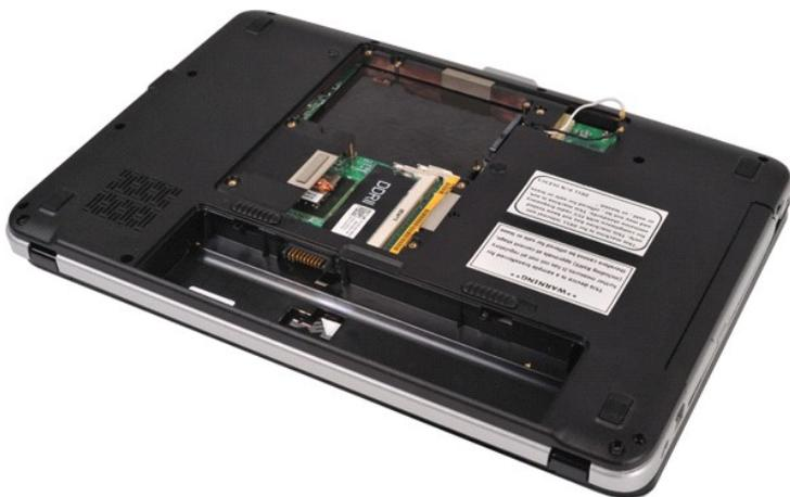
3. Quite los tres tornillos de la cubierta del panel de control de la parte inferior del ordenador.
