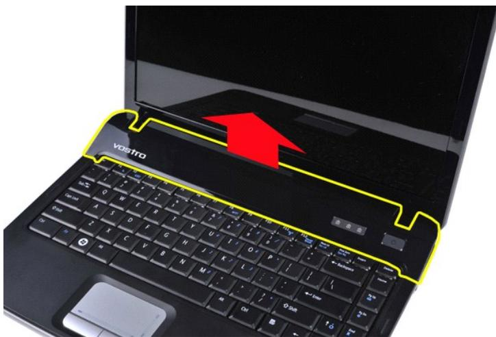
**Colocación de la cubierta del panel de control**
