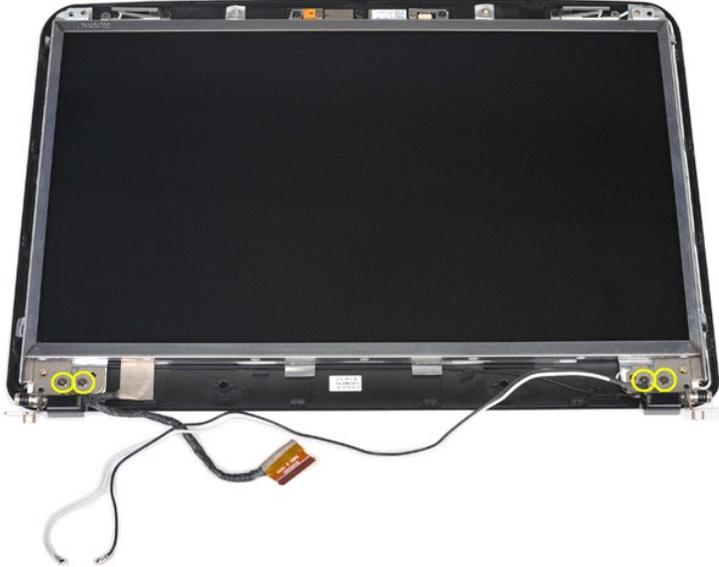
11. Desconecte el cable de la cámara de la pantalla.
