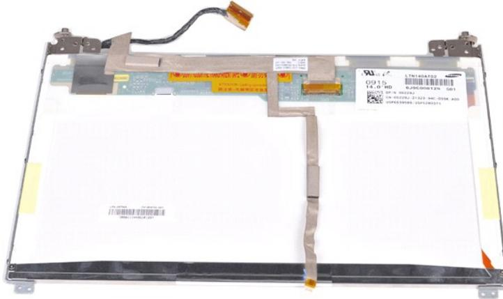
12. Separe y extraiga con cuidado el cable del inversor de la pantalla del panel de la pantalla LED.
