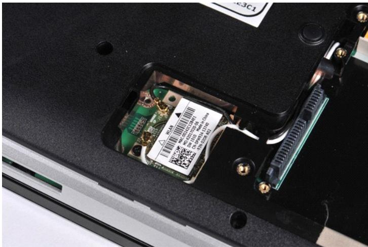
5. Desconecte los cables de antena de la tarjeta WLAN.
