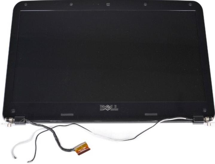
9. Utilice un instrumento de plástico acabado en punta para quitar las seis cubiertas de goma de los tornillos del conjunto de pantalla.
