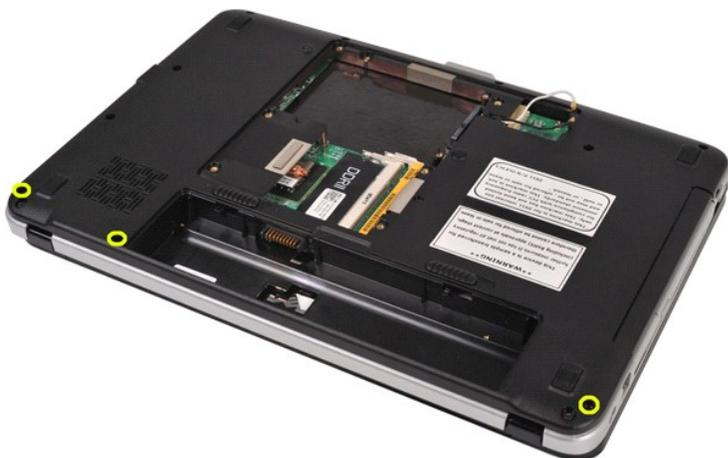
4. Inserte un instrumento de plástico acabado en punta para liberar los cuatro ganchos de la cubierta del panel de control en el interior del hueco para la batería.
