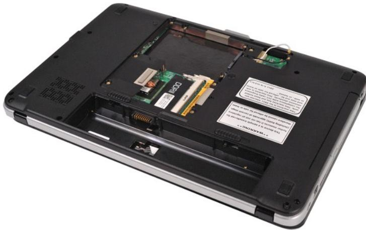
3. Quite los ocho tornillos de la cubierta del panel de control de la parte inferior del ordenador.
