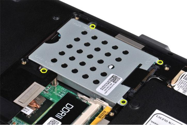
5. Tire de la lengüeta de mylar hacia el conjunto de unidad de disco duro para liberar la placa mediadora de la unidad de disco duro del conector de la placa base.
